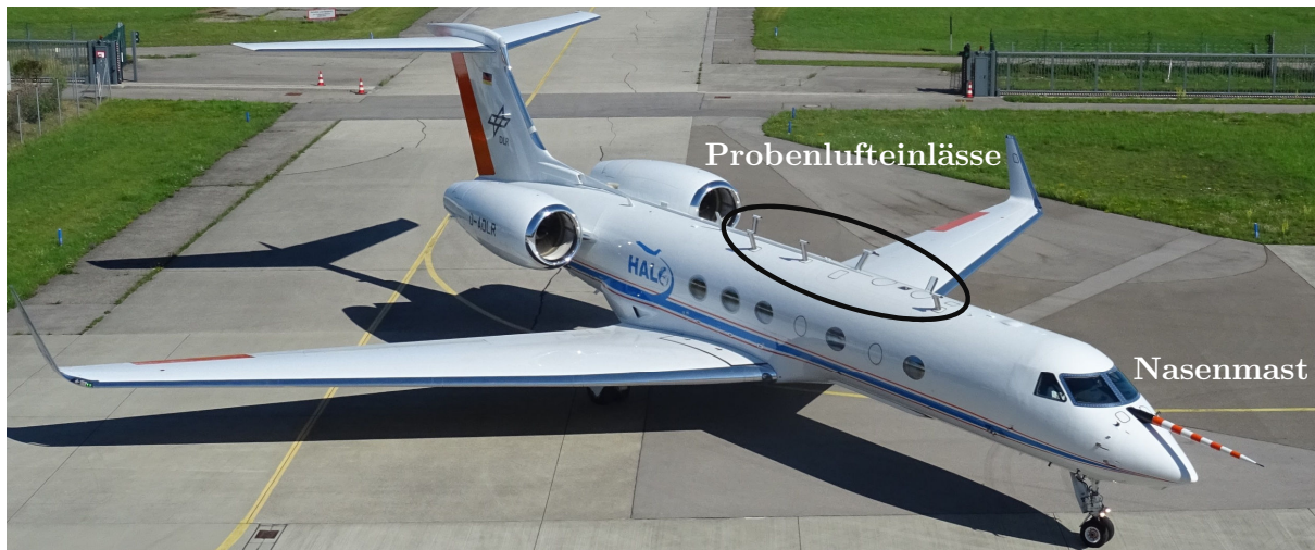
Abbildung 3.13: Das deutsche Forschungsflugzeug HALO auf der Basis in Oberpfaffenhofen. Verschiedene Probenluft einlässe befinden sich auf dem Dach, die Sensorik für Temperatur-, Feuchte- und Windmessung im Nasenmast (Krautstrunk und Giez, 2012; Giez et al., 2021).
