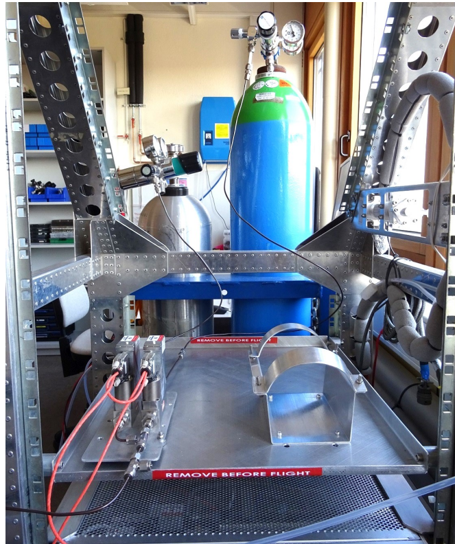
Abbildung 3.10: Die integrierte Kalibrierungs-Einheit des HALO PTR-MS während des Laborbetriebs mit VOC-Gasstandard (silberner Zylinder) und synthetischer Luft (blauer Zylinder) sowie den zugehörigen Flussreglern (vorne links). In der Halterung (rechts) kann ein weiterer kleiner VOC-Gasstandard (2 Liter) zur mobilen Kalibrierung am Boden fixiert werden.
