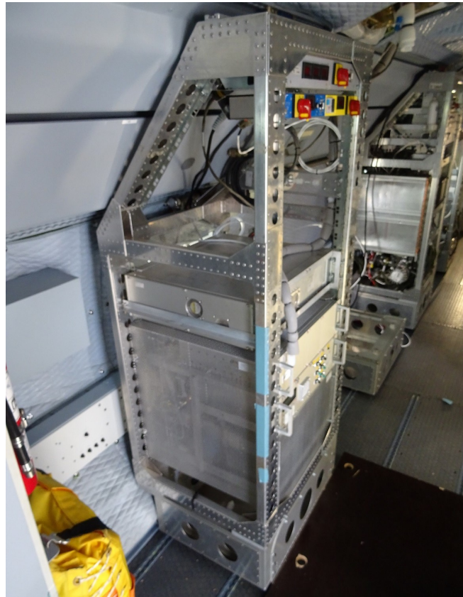
Abbildung 3.1: Das HALO PTR-MS im unteren Teil eines luftfahrtzertifizierten Gestells im Forschungsflugzeug HALO.
