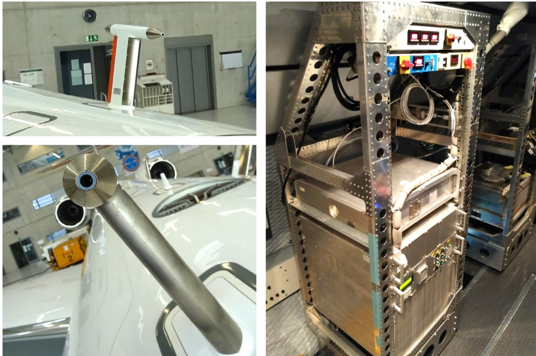
Abbildung 3.14: Links: Spurengas-Einlass TGI auf den Flugzeugdach von HALO. Rechts: Gestell des HALO PTR-MS integriert auf HALO während der Kampagne EMeRGe.
