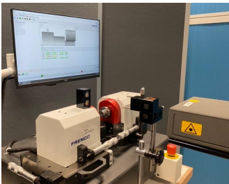
Abbildung 0-3: Messaufbau des Interferometers Y-Achse (links) und Achsfehler Y Grafik (rechts)
