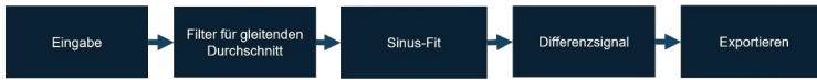
Abbildung 7-5: Optimiertes Filter zur Extraktion der kurzwelligen Komponente des Übertragungsfehlers (Gauder et al. 2022b)
