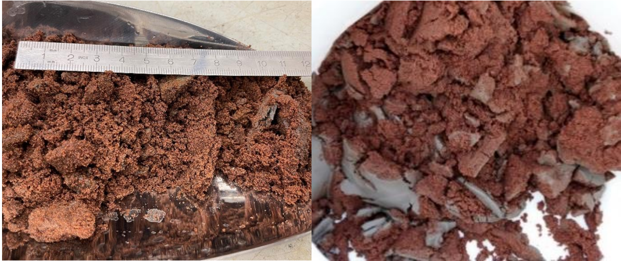
Abbildung 3.20: Feuchtes Probenmaterial (Gemisch 1.4307): Abrasiv (rot) und Stahlpartikel (grau)
