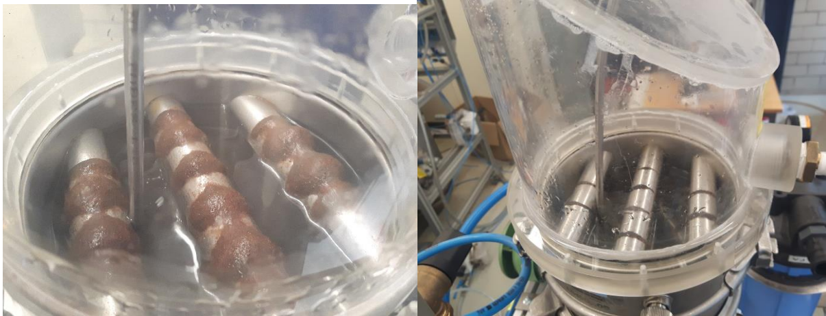
Abbildung 4.14: Hüllrohre mit Abrasivpartikeln (links) und mit Einsatz von Druckluftumspülung (rechts)
