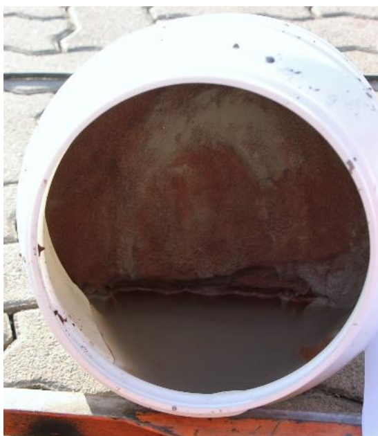
Abbildung 3.22: Probenmaterial mit Wasserüberstand nach Abfüllen in Fässer
