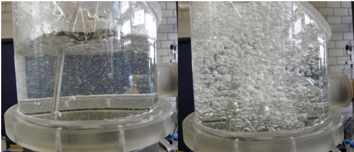
Abbildung 3.12: Magnetfilter ohne Einsatz von Druckluft am Gehäuseboden (links) und mit Druckluft (rechts)
