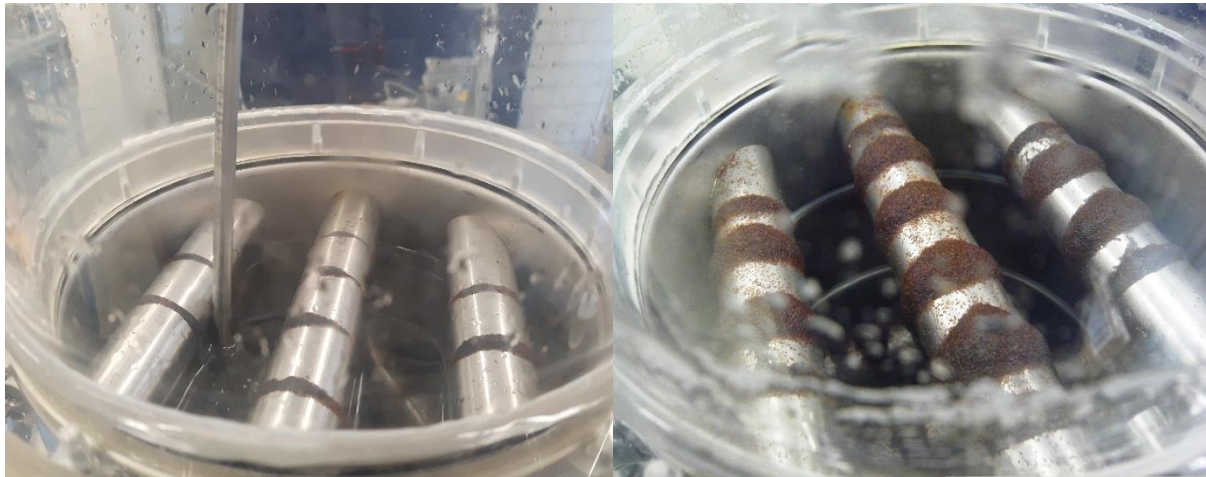
Abbildung 3.13: Beladung der Hüllrohre nach Magnetfiltration mit und ohne Druckluftumspülung
