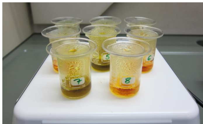
Abbildung 3.26: Säureaufschluss von Abrasiv-Stahl-Proben auf einer Heizplatte
