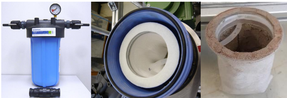
Abbildung 3.14: Beutelfiltergehäuse (links), neuer Filterbeutel, 1 \mu\text{m} (Mitte), mit Feingut beladener Filterbeutel nach Siebung (rechts)
