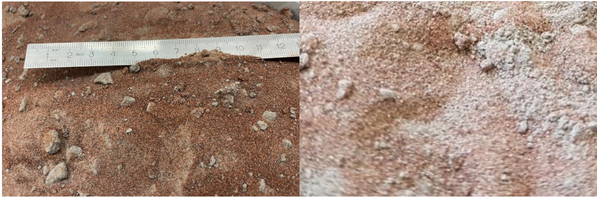
Abbildung 3.23: Getrocknetes Probenmaterial mit Agglomeraten (links), zerkleinerte Agglomerate (rechts)
