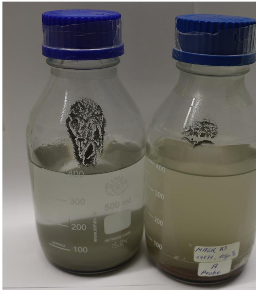
Abbildung 3.16: Vergleich der magnetischen Eigenschaften der Stahlpartikel (links 1.4307, rechts 1.4571)
