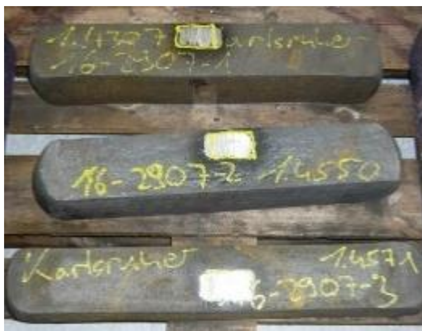
Abbildung 3.17: Vierkantstähle aus Edelstahl vor der Probenherstellung
