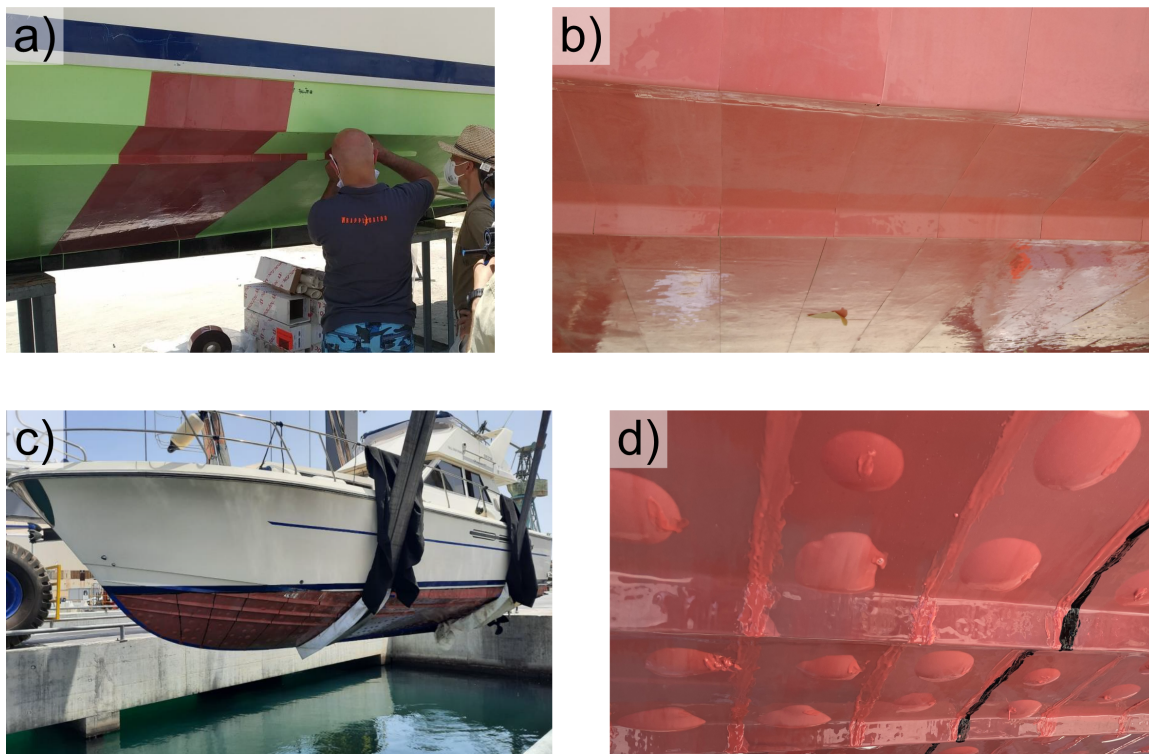
Abbildung 6.12: Beschichtung des Forschungsschiffes. a) Die einzelnen Bahnen wurden durch einen „Replicator“ vom Kiel zur Wasserlinie hin verlegt und unter Spannung andrückt. Eingeschlossene Luftblasen wurden mit einem Fugenglätter zum Rand hin ausgestrichen. b) Beim Anbringen einer neuen Bahn überlappte diese zunächst mit der vorigen. Nach dem Schneiden mit einem Cuttermesser wurden beide Randstücke entfernt. Als Ergebnis erhielt man parallel zueinander verlaufende Bahnen. c) Die Schutzfolie verhinderte beim Eintauchvorgang, dass verschmutztes Wasser an die Folie gelangte und verhinderte Strukturbeschädigung an der Folie durch den Gurt. d) Damit unter Wasser ein Luftreservoir für die Füllung der Folie zur Verfügung stand, waren Luftpolster zwischen PE-Folie und Schutzfolie eingearbeitet (alle aus [86]).
