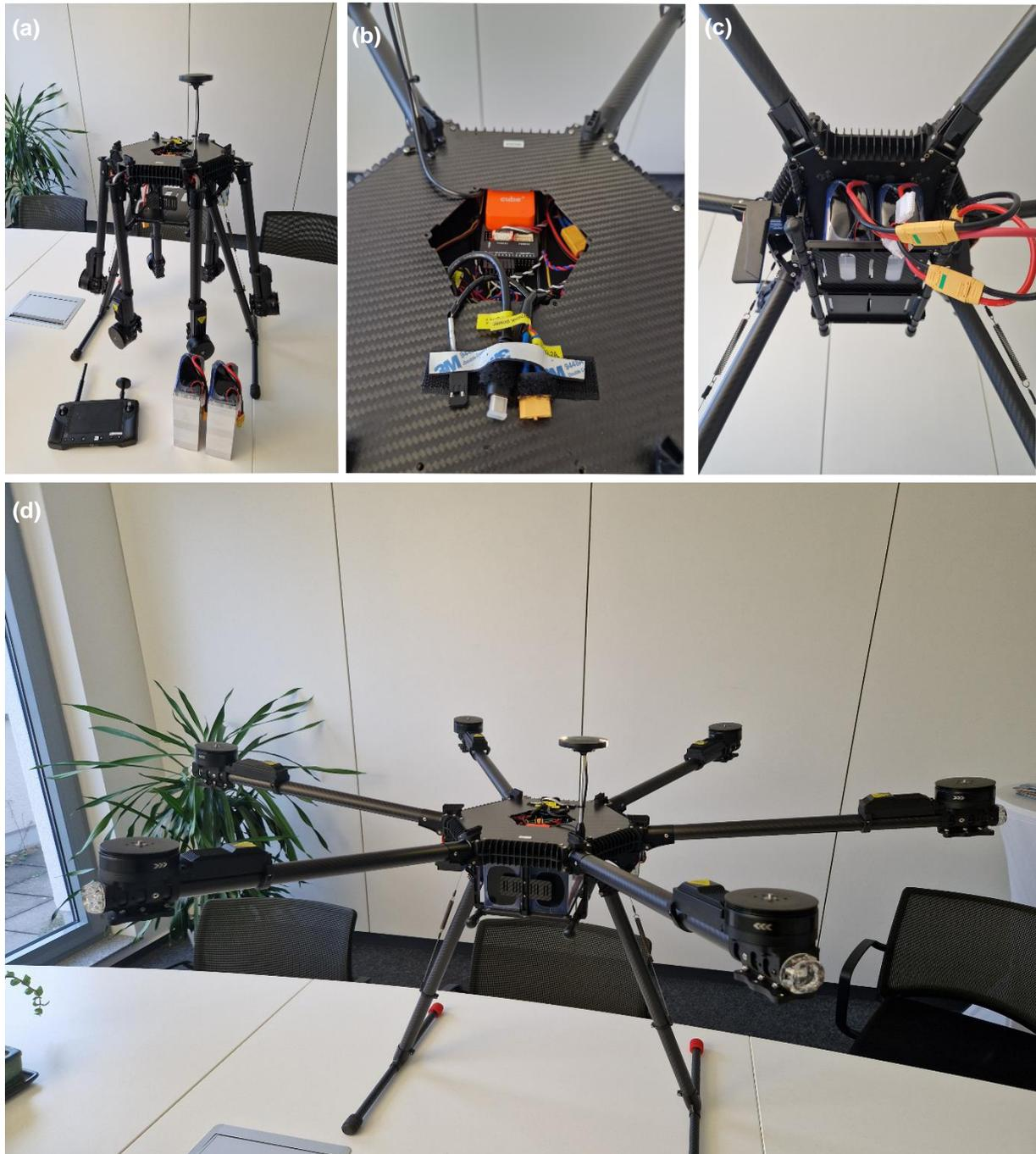
Abbildung 9: Entwickelte Hexacopter-UAV-Plattform in verschiedenen Ansichten. (a) UAV zusammengeklappt mit HereLink, (b) Zentraleinheit des UAV mit Pixhawk Cube Orange, (c) Akkuschacht und Payload-Areas, (d) UAV ohne Top-Cover ausgeklappt.
