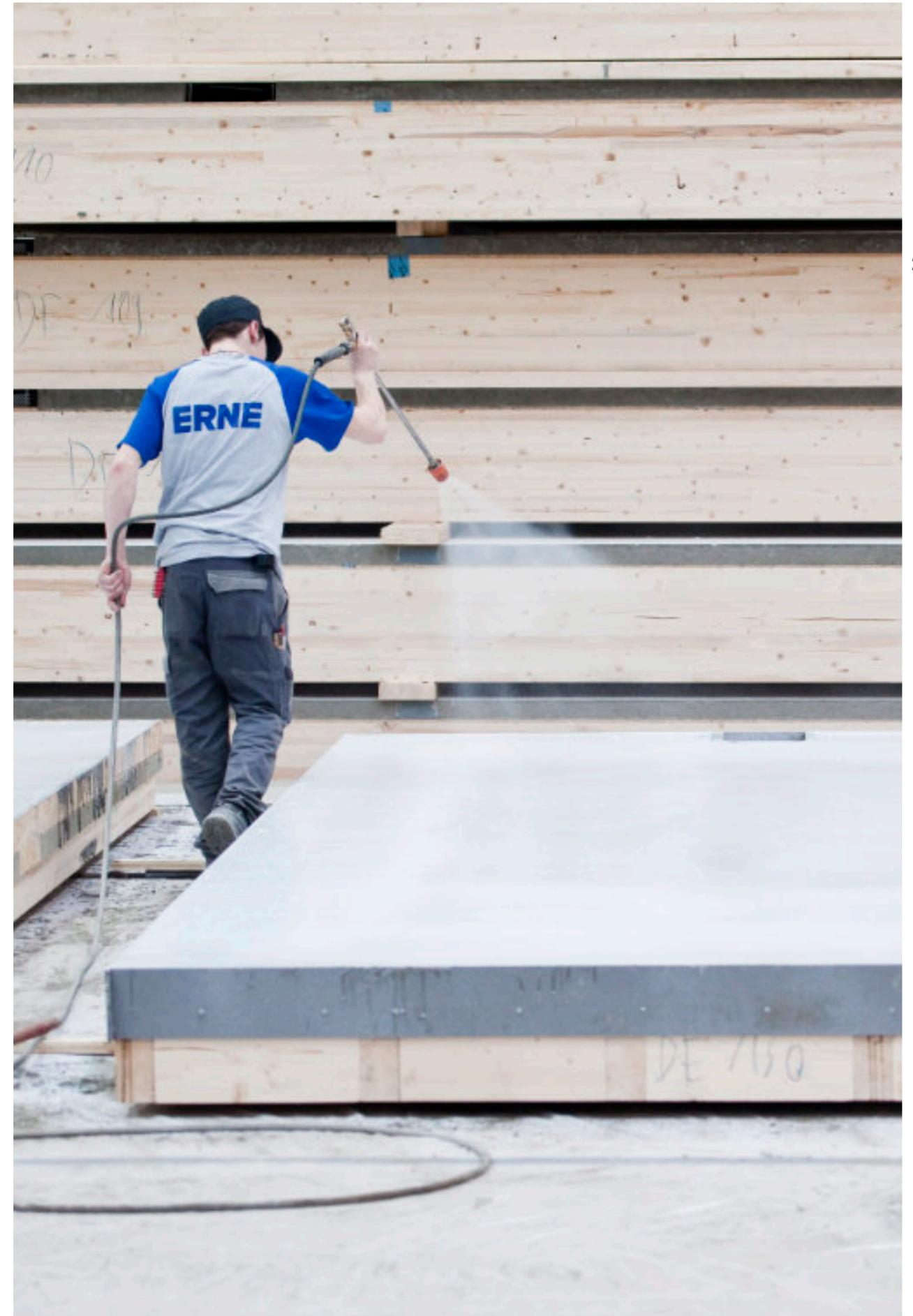
Produktion von Holz-Hybrid-Decken
