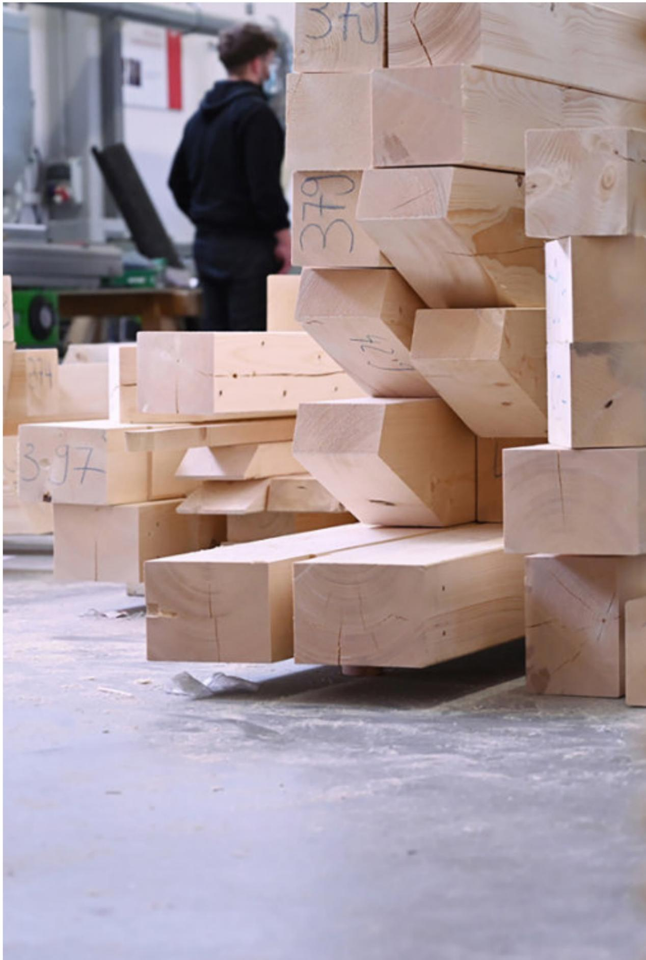
Abbund von Konstruktionsvollhölzern für ein sortenreines Tiny-House
