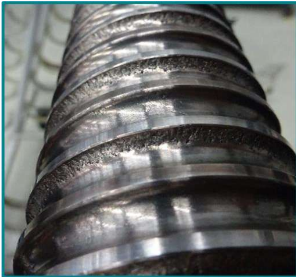
Ermüdung der Spindellaufbahn: Grübchenbildung auf Spindellaufbahn nach Ermüdungsversuch
