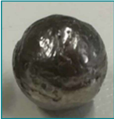
Ermüdung Kugel: Bild einer Kugel mit Ermüdungsschäden (links), Computertomographischer Scan der Kugel (rechts)
