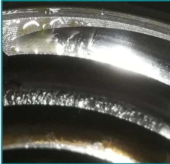
Ermüdung der Mutter: Grübchenbildung auf Muttergewindengang
