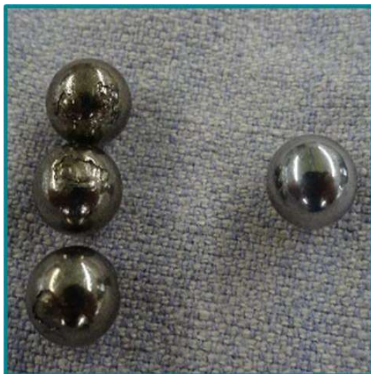
Heißlaufschiiden: Verfärbung aufgrund von hohem Hitzeeintrag (ebenfalls Abplatzung von Ermüdungsschiiden)
