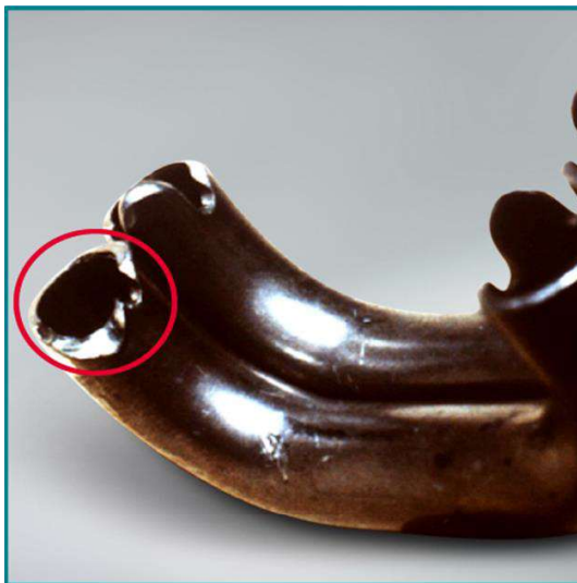
Bauteilversagen Umlenkung: Bruch der Umlenkung durch Überlast oder Verklemmen (NSK Europe LTD 2021)
