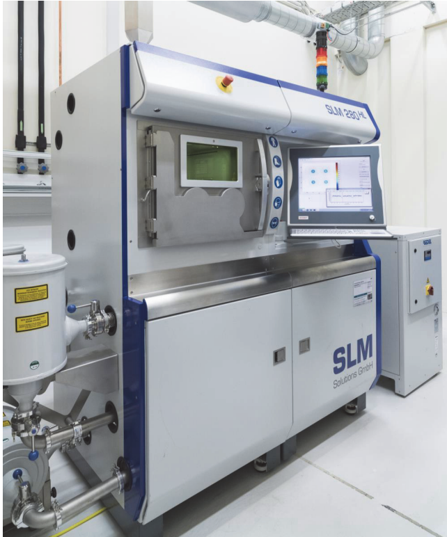
Abbildung 4-2: Verwendete Versuchsanlage SLM 280HL (Photo KIT/Breig)
