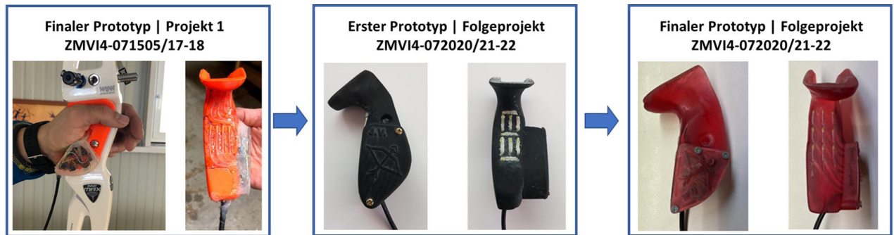
Abb. 1: Prototyp des vorherigen Projekts mit 8 Sensoren (links), erster Prototyp (Mitte) und finaler Prototyp (rechts) mit 9 Sensoren unterschiedlicher Anordnung des vorliegenden Serviceforschungsprojekts.
