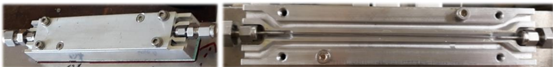
Abb. 26: MURSS-2: Kapillare im eingebauten Zustand innerhalb der Vorrichtung (Links mit Abdeckung zur Fixierung der Kapillare, rechts ohne Abdeckung).
