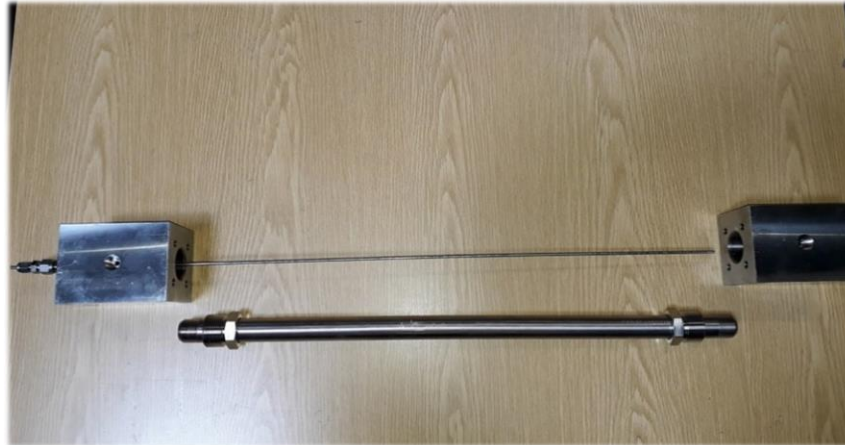
Abb. 25: Inlet- und Outlet-Anbindung eines MURSS-2-Reaktorrohrs mit Dichtungsringen und axialem konzentrischen Hüllrohr zur Messung von Temperaturprofilen.
