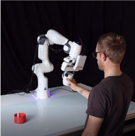
Abbildung 24: Technischer Aufbau von Experiment II mit Panda-Roboterarm und Greifer von Franka Emika.
