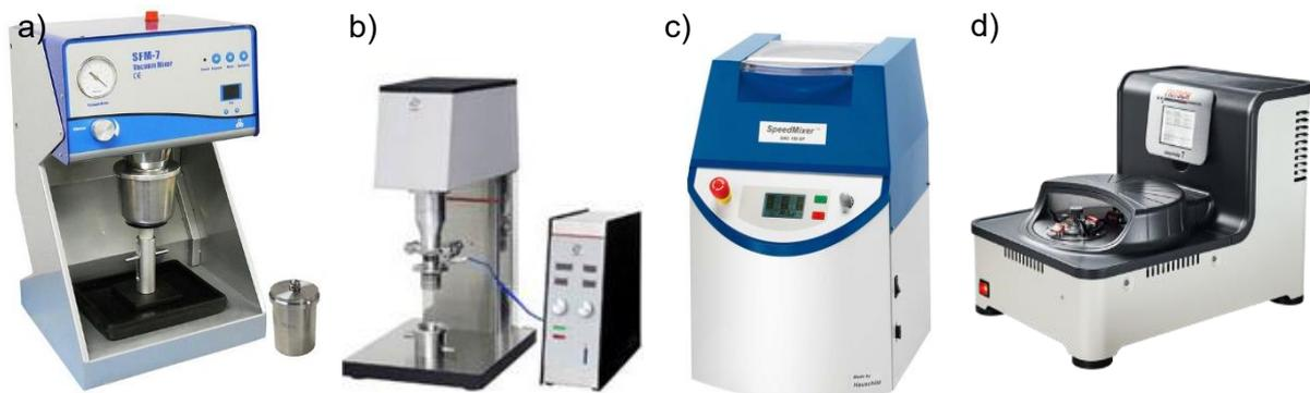
Abb. 4-2: Die verwendeten Mixer und Homogenisatoren: a) Vakuumrührer SMF-7 (MTI Corporation, USA), b) FILMIX Model 40L (Primix Corporation, Japan), c) SpeedMixer™ DAC 150 SP (Hauschild & Co. KG, Deutschland) und d) Planetenkugelmühle Pulverisette 7 premium line (Fritsch GmbH, Deutschland).
