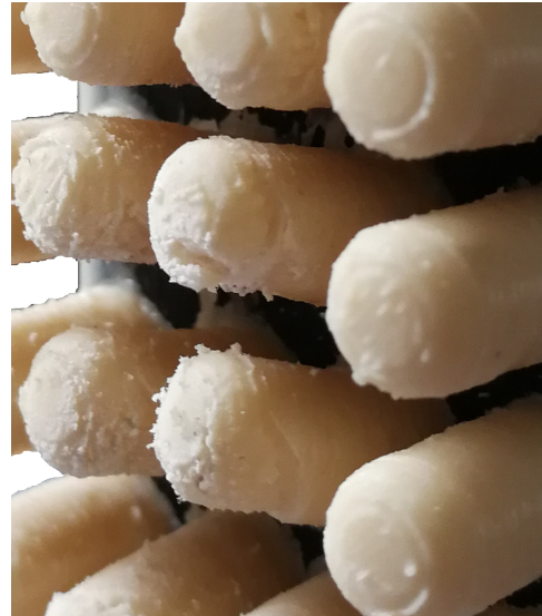
(b) Gegossenes Elastomerprofil nach wiederholter Nutzung
