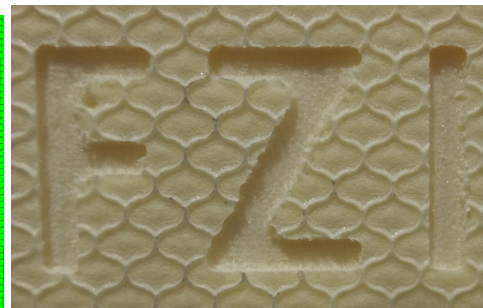
(b) Das mit dem vorgeschlagenen System gefräste Logo. Eine Anpassung des Quellcodes war nicht erforderlich, es wurden lediglich die Daten des Logos und des Blocks geändert. Quelle [185].
