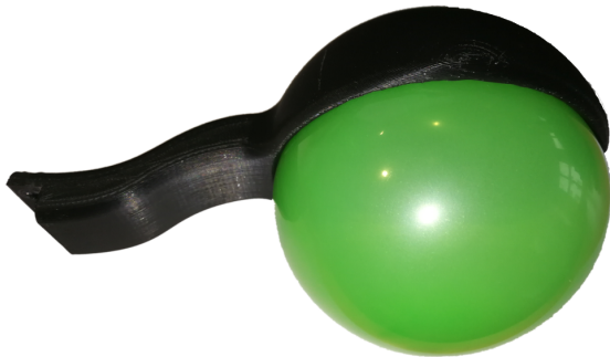
(c) Luftgepolsterter Greiferfinger. Versatz: -10 mm, Abdeckung: ~ 56%
