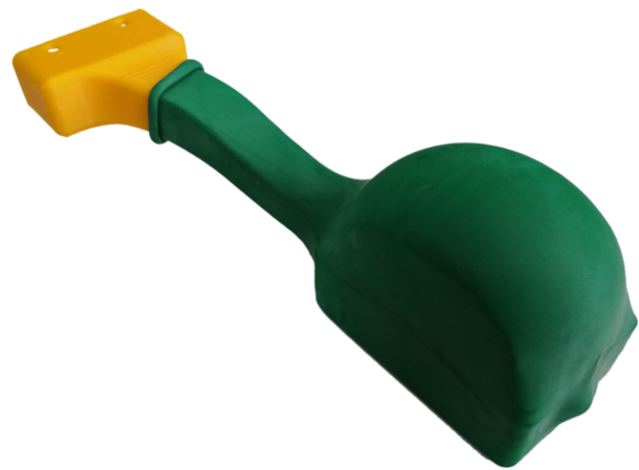
(d) Mit Polyurethanschaum gepolsterte Greiferfinger. Versatz: 0 mm, Abdeckung: ~ 63%
