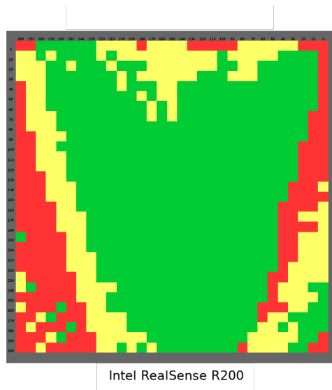
Abbildung 3.7.: Die Verteilung der Extrudererkennung in der XY-Ebene für die Druckplatte des ideaMaker-Druckers. Die Farben zeigen an, an welcher Stelle der Extruder zuverlässig erkannt werden konnte. In der Regel werden Objekte in der Mitte der Druckplatte gedruckt, so dass Druckvorgänge problemlos überwacht werden können. (Grün = zuverlässige Erkennung, Gelb = schwankende Erkennung, Rot = keine Erkennung). Quelle [192].
