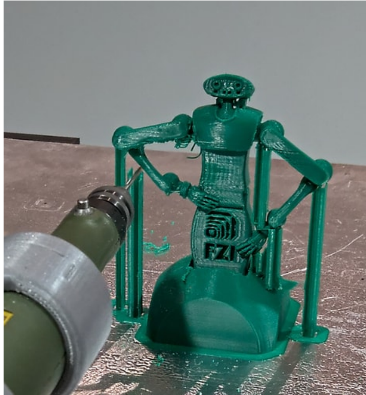
Abbildung 5.9.: Das Robotermodell bei der Nachbearbeitung und Entfernung mehrerer Säulen der Stützstruktur aus dem Druck. Die ersten Säulen sind bereits entfernt worden. Quelle [185].
