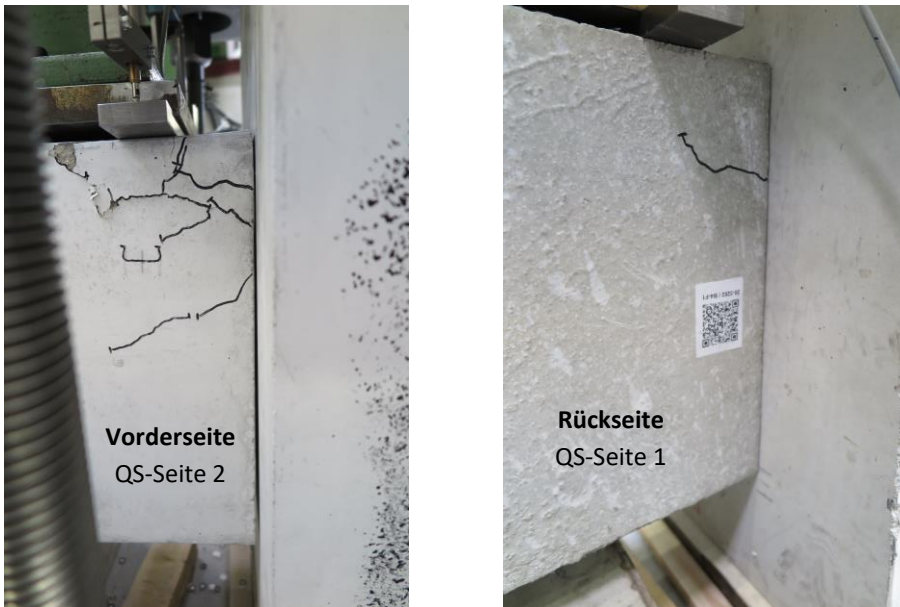
Abbildung B.6: Rissverlauf am Tragelement beim Erreichen der Tragfähigkeit (787 kN), Versuch Nr. 4
