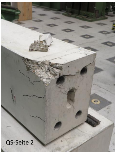
Abbildung B.9: Versagtes Tragelement am Versuchsende, Versuch Nr. 4
