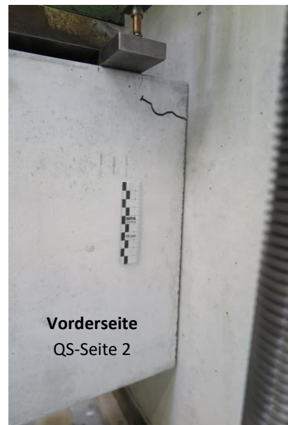
Abbildung B.3: Rissverlauf am Tragelement bei Erreichen einer Kraft von 582 kN, Versuch Nr. 4
