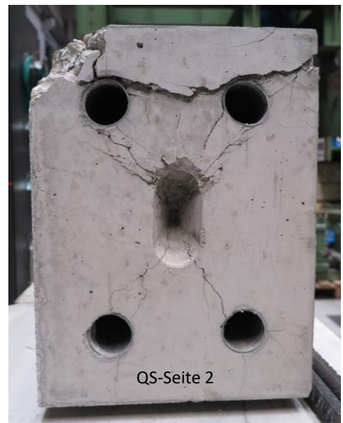
Abbildung B.9: Versagtes Tragelement am Versuchsende, Versuch Nr. 4
