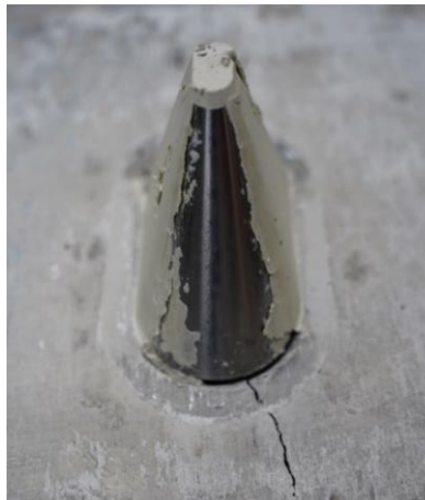
Abbildung 4.26: Freigelegter Kontaktbereich des Zusatzelementes nach dem Versuchsende
