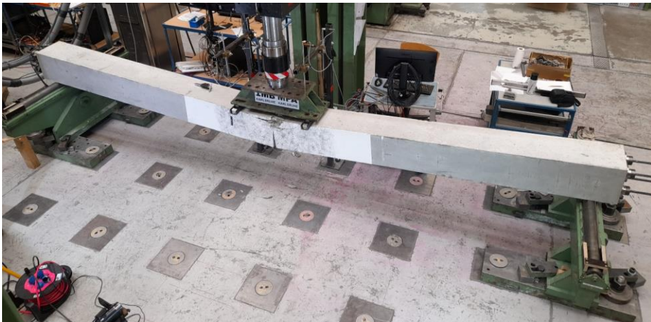
Abbildung 4.58: Verformter Versuchsbalken Nr. 2 mit der versagten Druckzone bei einer Durchbiegung von ca. 200 mm in Feldmitte am Versuchsende
