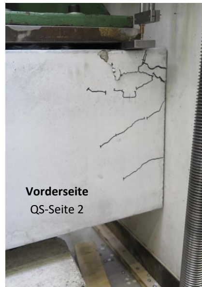
Abbildung B.8: Rissverlauf am Tragelement beim Erreichen der Tragfähigkeit (787 kN), Versuch Nr. 4
