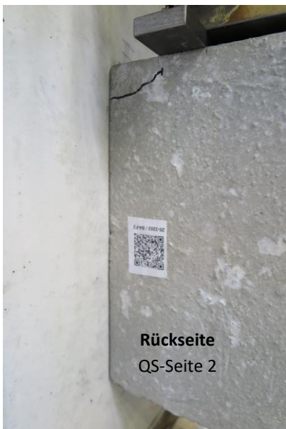
Abbildung B.3: Rissverlauf am Tragelement bei Erreichen einer Kraft von 582 kN, Versuch Nr. 4
