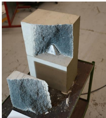
Abbildung 4.25: Beispielhaftes Foto eines versagtes Betonkörpers
