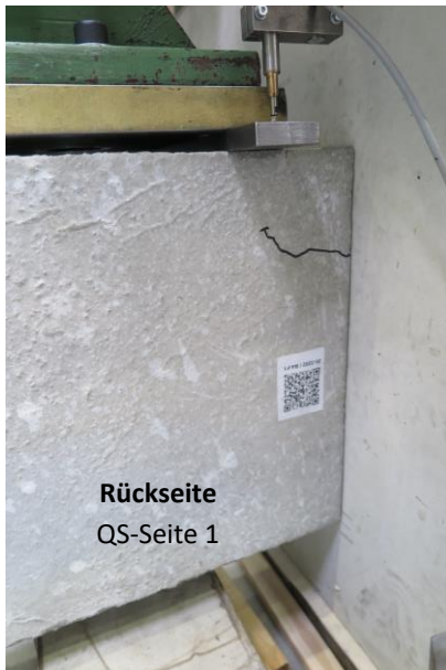
Abbildung B.8: Rissverlauf am Tragelement beim Erreichen der Tragfähigkeit (787 kN), Versuch Nr. 4
