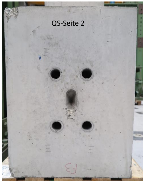
Abbildung B.10: Ansicht des Grundkörpers zugehörig zur versagten Seite des Tragelementes am Versuchsende, Versuch Nr. 4
