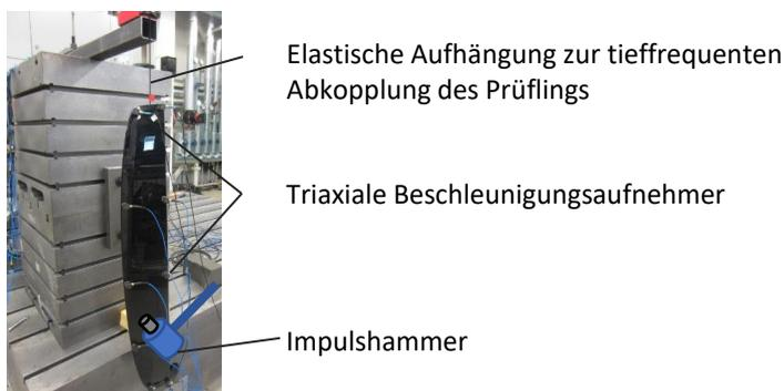
Abbildung 5.2: Messaufbau zur Modalanalyse eines Spoilerblattes mittels Impulshammermessung
