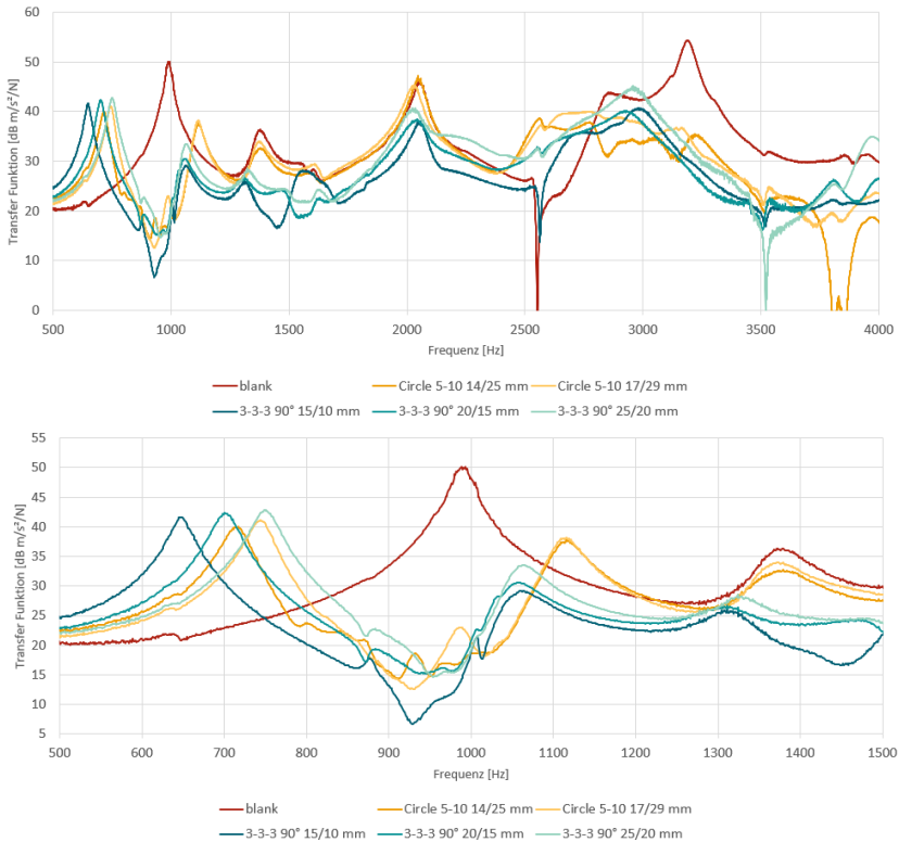
Abbildung 6.32: FRFs einiger ausgewählter Varianten, Zielfrequenz der Resonatoren beträgt 1000 Hz. Oben: Übersicht 0,5 – 4 kHz; Unten: Detailansicht 0,5 – 1,5 kHz. (Bopp & Albers, 2022b)
