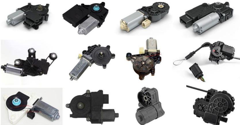
Abbildung 6.1: Übersicht über verschiedene Bauarten von Komfortaktuatoren. In Anlehnung an Huang (2018) 8 , Continental (2022), Huf Hülsbeck & Fürst (2022) und Bosch (2022)
