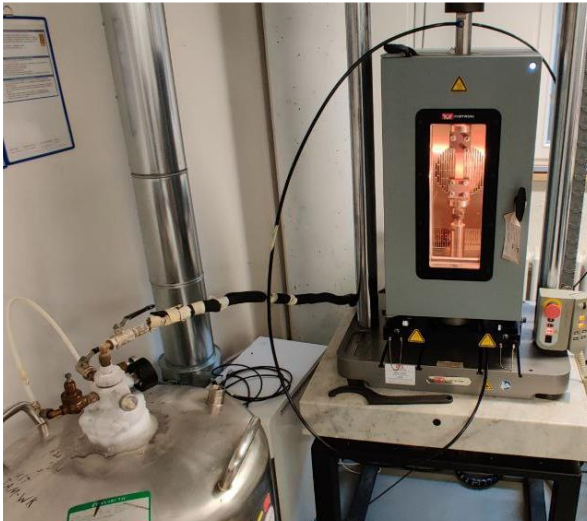
Abbildung 2.49: Versuchsaufbau zur Durchführung der dynamisch-mechanischen Analyse mit Zugvorrichtung und Temperierkammer, links im Bild ist der Tank für den flüssigen Stickstoff zu sehen. (Sleiman, 2020)
