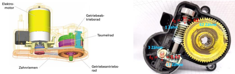
Abbildung 6.2: Innenleben zweier beispielhafter Komfortaktuatoren. Links: CAD Darstellung mit transparentem Gehäuse; rechts: geöffnetes Gehäuse einer Parkbremse. In Anlehnung an Huang (2018)
