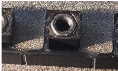
Abbildung 5.24: Links: FEM Simulation, erste Mode bei 953 Hz. Rechts: pausierter Druck mit eingesetztem M3 Insert. (Bopp & Albers, 2022b)
