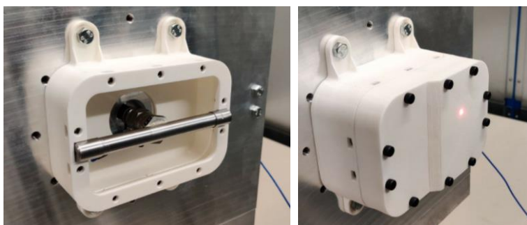
Abbildung 7.1: Oben: CAD-Darstellung des Validierungs-Gehäuses. Unten: Aufgebautes Gehäuse für PSV-Messungen
