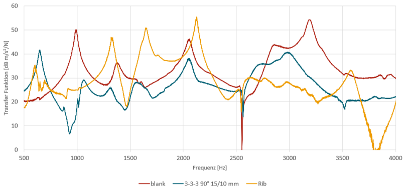
Abbildung 6.34: Vergleich der gemessenen FRFs einiger signifikanter Varianten: Leeres Gehäuse („Blank“, rot), Gehäuse mit Rippe („Rib“, gelb), Gehäuse mit VAMM in 3-3-3 Layout (blau). (Bopp & Albers, 2022b)
