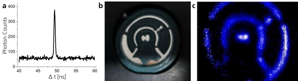
Abbildung 3.12: Erzielte Ergebnisse mit dem Proof-of-Concept Aufbau, gezeigt in Abbildung 3.10. Bei der Messung mit diesem Aufbau entstehen eigentlich 2 Bilder, da das Array über 2 Sensor-Zeilen verfügt. Hier wird allerdings nur das Bild der unteren Zeile gezeigt. Weitere Details zur Messung und den Bildverbesserung können der Original-Publikation [38] entnommen werden. (a) Koinzidenz-Auswertung einer Zeile (Zeile 26). Der Koinzidenz-Peak konnte dank der Korrekturen in Abbildung 3.11 auf 1 ns reduziert und Die CAR auf \sim 4 erhöht werden. (b) Die zur Bildgebung genutzte Transmissions-Blende, bestehend aus einem „Geist“. (c) Koinzidenz-Bild nach Hintergrund-Abzug und Bild-Verbesserung, wie in [135] beschrieben. Durch die Einkopplung wurde ein Teil des Bildes abgeschnitten (links unten). Die dunklen, vertikalen Streifen wurden durch verrauchte Pixel verursacht, die in der Daten-Aufnahme gefiltert wurden.
