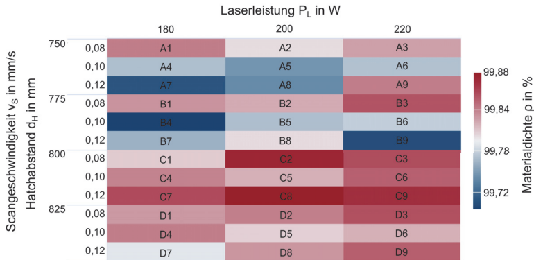
Abb. 5.3: Grafische Aufbereitung der parameterabhängigen Materialdichte zur Auswahl von Parametersatz C8 für die weitere Fertigung von Probekörpern
