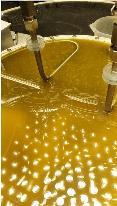
Abbildung 7.32: Kontamination im Membranreaktor
