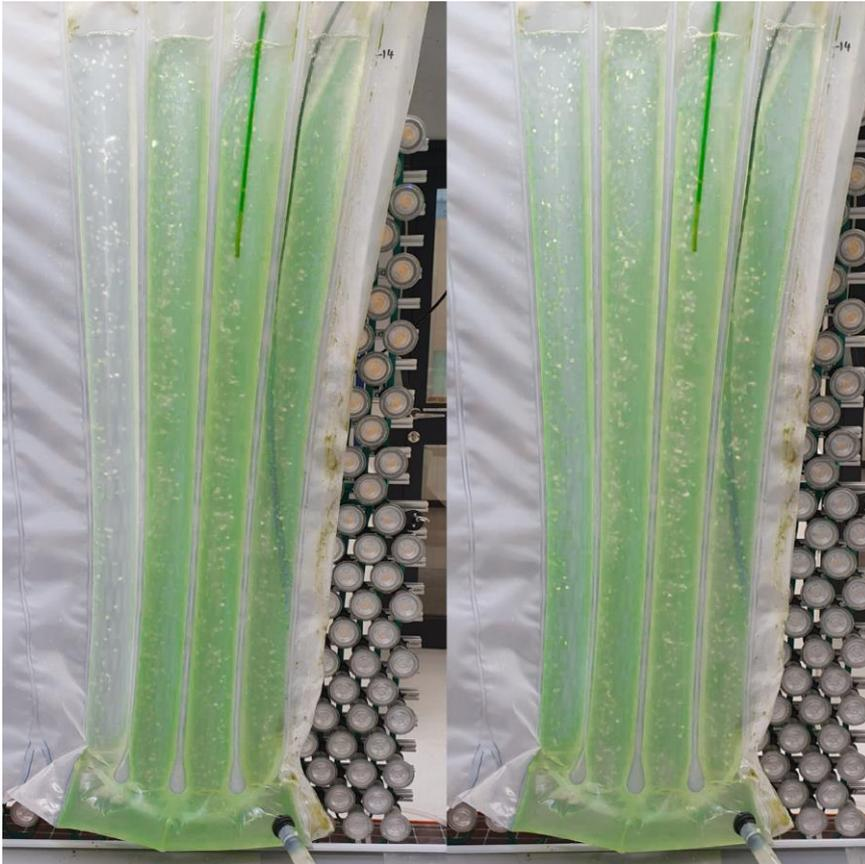
Abbildung 7.30: Bestimmung der Makromischzeit des Schlauchreaktors: Links: nach 3 Stunden. Rechts: Nach 16 Stunden. Die Sättigung der Farben wurde verstärkt
