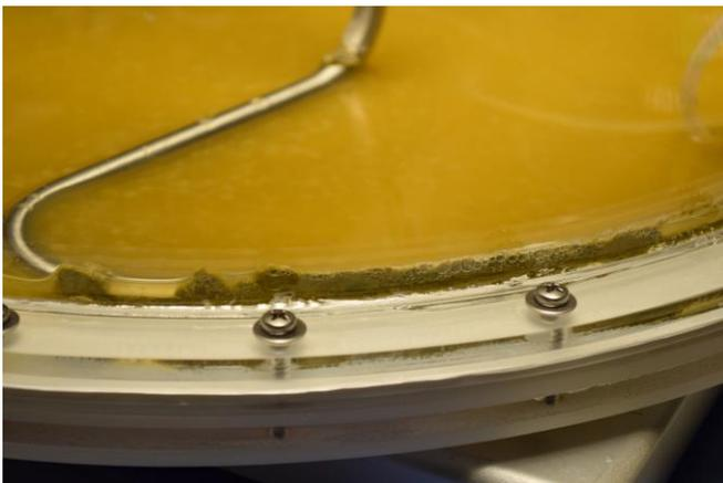
Abbildung 7.31: Zellansammlungen zwischen Reaktorwand und Kühlschlange im Membranreaktor
