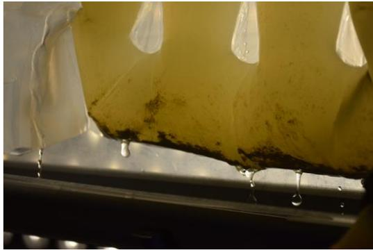
Abbildung 7.25: Ablagerungen im Schlauchreaktor
