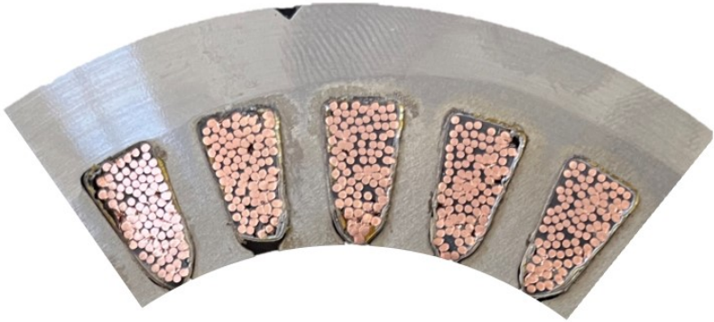
Abbildung 5.8: Schliffbild der analysierten Nut der Prüflingsmaschine nach Abschnitt 7.2
