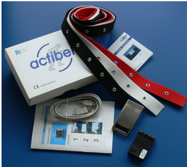
Abbildung 9: Das actibelt Paket mit einer Gürtelschnalle, einer schwarzen Messbox, drei Gurten in verschiedenen Farben, einem USB-Kabel, einer Bedienungsanleitung und einer Kurzanleitung. Quelle: SLCMSR 2008.
