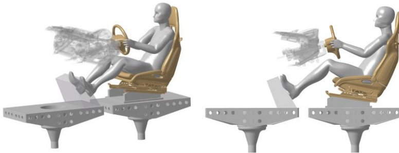
Abbildung 20:Prinzipieller Aufbau Fahrkomfort-Simulator (Illustration links vorveröffentlicht in [11])
