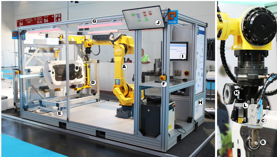
Abbildung 5.19.: BMW Demonstrator zur evaluation und Präsentation der Fähigkeitsmodellierung auf der Automatica 2016. A: FANUC M-710iC/50, B: Walze, C: TCP Pneumatik C: pneumatischer TCP-Zylinder, D: Türbefestigung, E: RFID-Leser, F: Sicherheit (ausgewertet mit traditioneller SPS), G: Statusleuchten (gesteuert durch Sicherheits-Skill), H: Schaltschrank mit Integrationsplattform, I: ReApp Workbench, J: aktueller Prozessstatus, K: FANUC Vision System, L: SICK Lichtreflexschalter.
