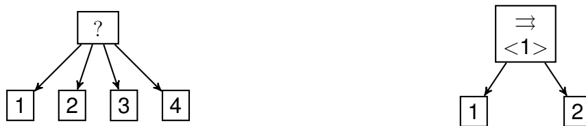
Abbildung 4.21.: BTs für die Berechnung der Werte in den Tabellen 4.1 und 4.2. Der Parallel-Knoten gibt success zurück, sobald eines seiner Kinder success zurückmeldet. Quelle [BH22]
