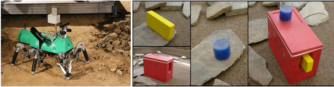
Abbildung 5.2.: Links: LAURON V Roboter beim SpaceBot Cup. Die Beine sind für das Laufen auf weichem Sand optimiert und mit einem speziellen Greifer für die Mission ausgestattet. Am Körper wurden spezielle Halterungen für die Zielobjekte angebracht und als Sensorik ein KaRoLa für hochauflösende 360° Laserscans verwendet. Rechts: Die zu findenden und aufzunehmenden Zielobjekte Batterie (gelb), Waage (rot) und Probenbehälter (blau) und die gewünschte Konfiguration zum Missionsende. Quellen: [Heppner et al., 2015]
