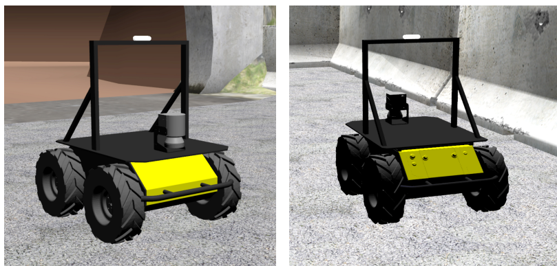
Abbildung 5.36.: Husky Roboter in der Simulationsumgebung. Der radgetriebene Roboter ist sehr kräftig und bringt einen UR5 Roboterarm als Payload mit, so dass er auch Objekte transportieren kann. In der Simulation wurde der Arm nicht explizit simuliert, da die Funktionalität nicht im Fokus der Arbeit steht. Quelle: [OH22]
