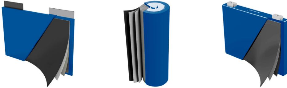
Abbildung 2.2.: Zellformate von LIBn von links nach rechts: Pouchzelle, Rundzelle und prismatische Zelle 15 (Lizenz CC BY 4.0)
