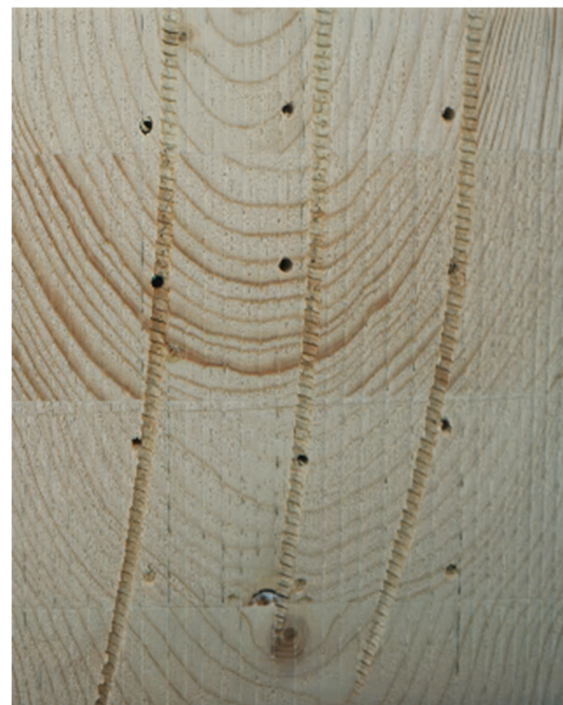
Abb. 12: Abweichen der vorgebohrten Schrauben 6 x 240 rechtwinklig zur Faser bei \alpha = 30^\circ .
