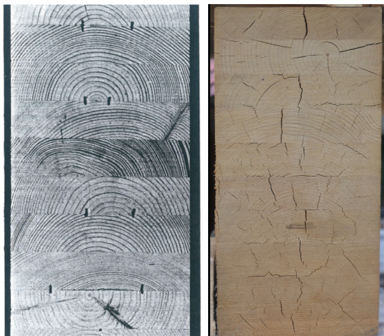
Abb. 15: Prüfkörperquerschnitt eines Brettschichtholzes mit inneren (latent) Querszugrissen infolge äußerer Feuchteinwirkung, Hirnholz abgedichtet, Rissbreite = jeweiliger Abstand zwischen zwei Markierungen, Quelle [33] (links) und Hirnholz eines im Alpenraum verbauten Brettschichtholzträgers mit natürlicher äußerer Rissbildung (rechts)
