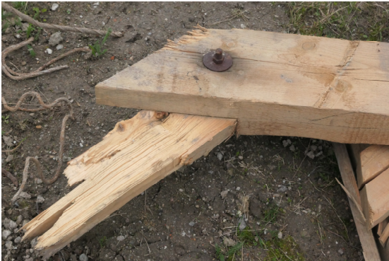
Abb. 8: Ausbauschaden infolge Zerreißen der Verbindung am First
