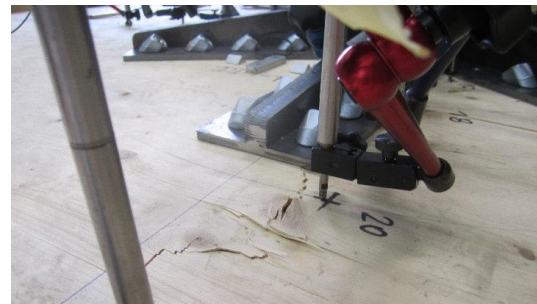
Abb. 10: Biegezugbruch an der Plattenoberseite [9]
