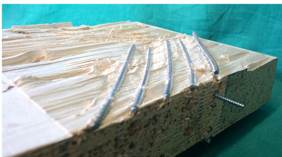
Abb. 13: Plastische Verformung der Schrauben 8x300 mm
