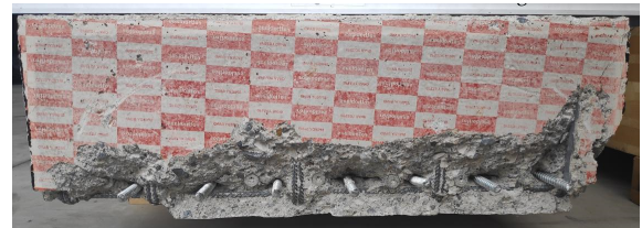
Abb. 22: Versagensmechanismen der Biegeversuche – Abplatzungen im Bereich des Übergreifungsstoßes und Stahlzugversagen der Vollgewindeschrauben
