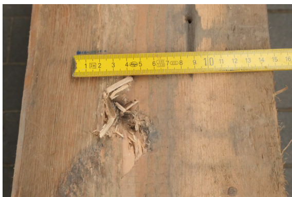
Abb. 12: Ausbauschaden an Kantholz, bei S10 tolerierbar
