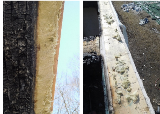
Abb. 20: Bauteilanschluss Decke-Wand 3, V4 aus TIMpuls
