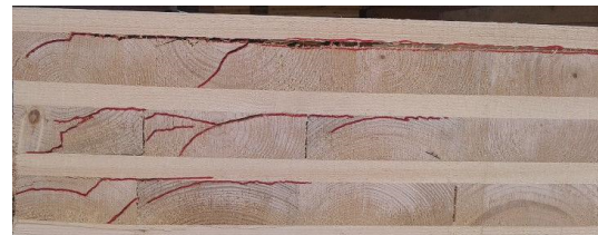
Abb. 9: Rollschubrisse (rot markiert) in den Querlagen [9]
