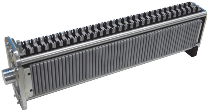
Abbildung 6-13: Aufnahme des prototypischen Wickelschwerts zur Überprüfung der Machbarkeit der Wickelmattenerstellung in der NWS/S.
