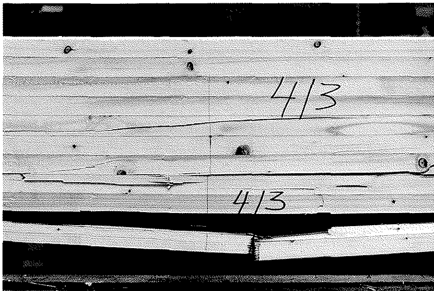
Bild 6.29: Versuchsträger 4/3 nach Erreichen der Höchstlast F_u = 88,7 \text{ kN}
