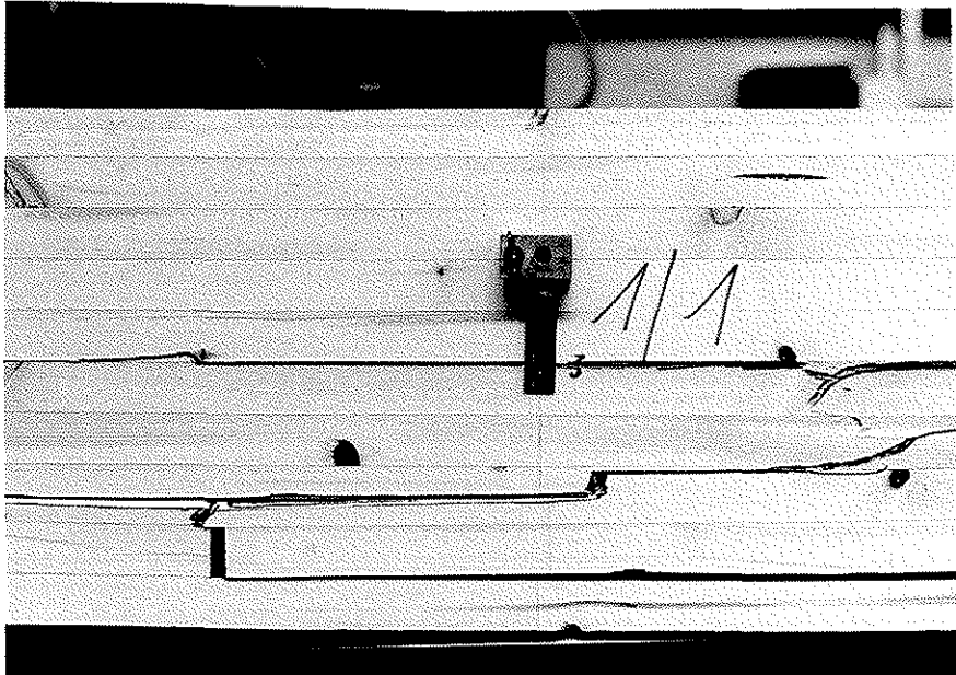
Bild 6.26: Versuchsträger 1/1 nach Erreichen der Höchstlast F_u = 67,9 \text{ kN}
