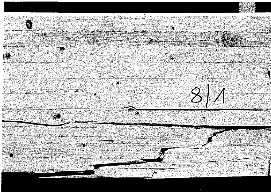
Bild 6.33: Versuchsträger 8/1 nach Erreichen der Höchstlast F_u = 55,2 kN
