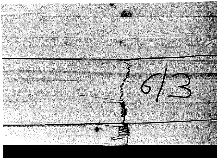
Bild 6.31: Versuchsträger 6/3 nach Erreichen der Höchstlast F_u = 77,1 \text{ kN}
