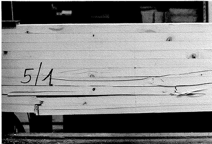
Bild 6.30: Versuchsträger 5/1 nach Erreichen der Höchstlast F_u = 81,8 \text{ kN}
