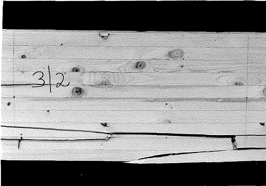
Bild 6.28: Versuchsträger 3/2 nach Erreichen der Höchstlast F_u = 82,4 \text{ kN}
