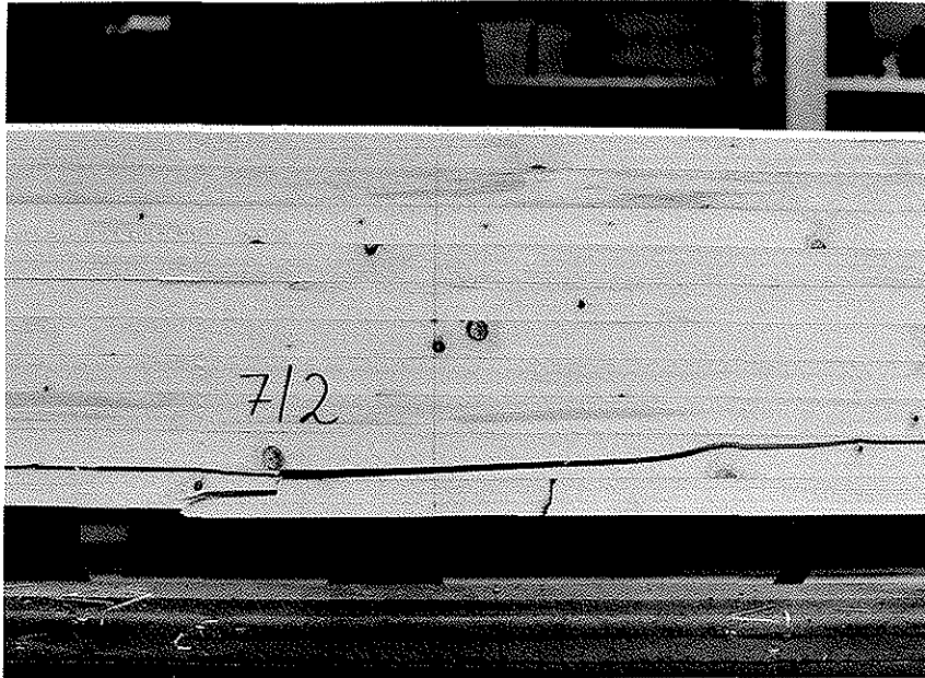
Bild 6.32: Versuchsträger 7/2 nach Erreichen der Höchstlast F_u = 74,2 kN
