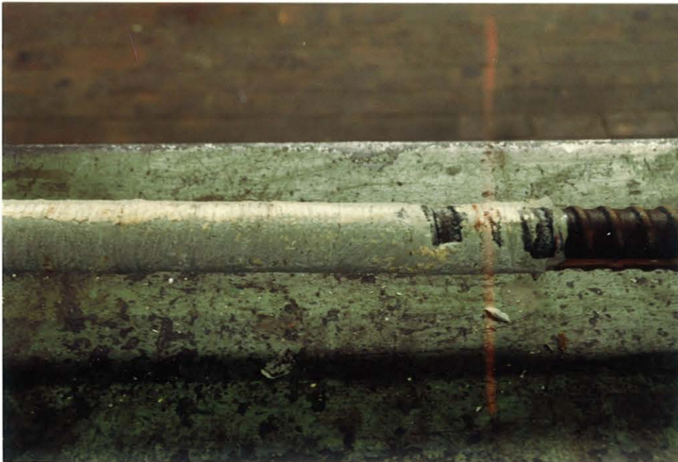
Bild 30: Mit Polyurethankleber behafteter GEWI-Stahl nach dem Ausziehversuch
