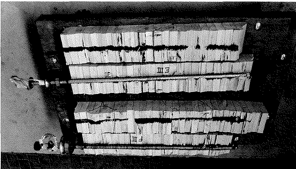
Bild 26: Prüfkörper E III L und F III L nach dem Ausziehversuch
