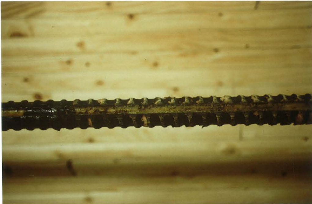
Bild 29: Mit Resorcinharz eingeleimter GEWI-Stahl nach dem Ausziehversuch
