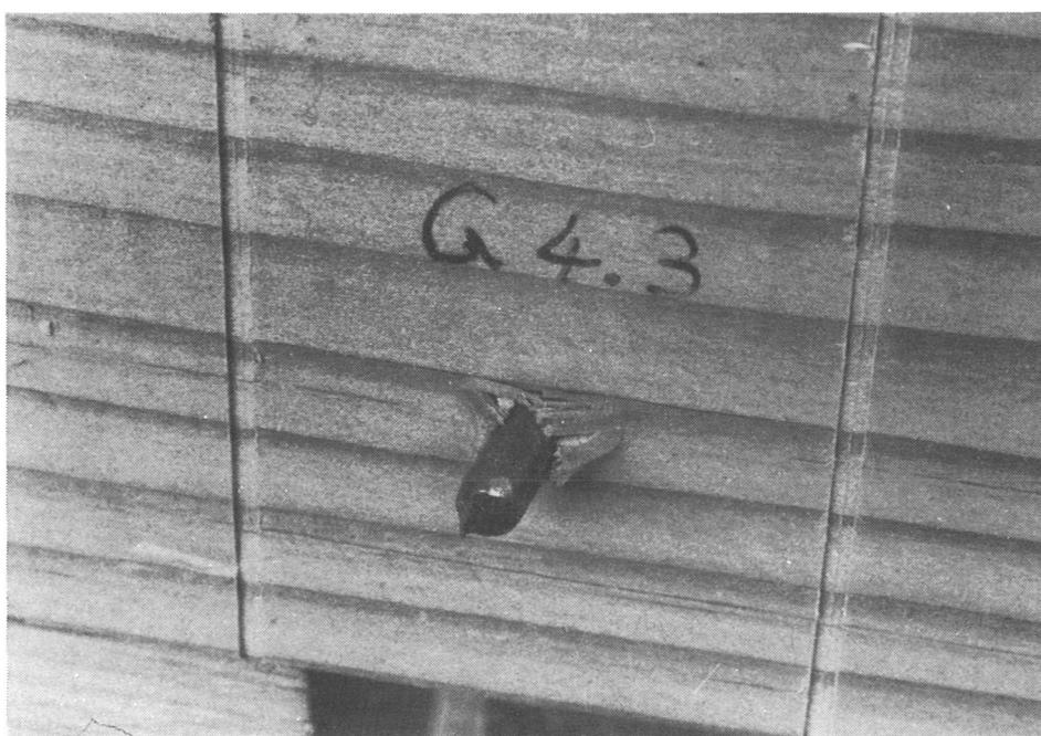
Bild 5: Nagel mit abgezwickter Spitze, auf Unterlage genagelt
