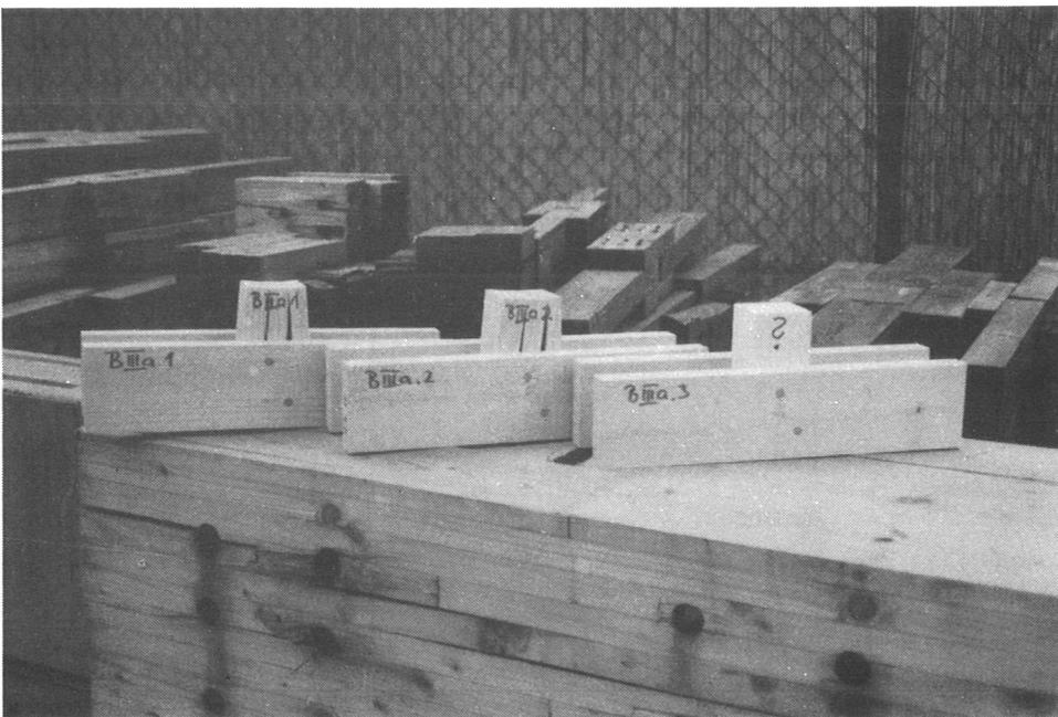
Bild 31: Vergleichsproben aus Fichtenholz
