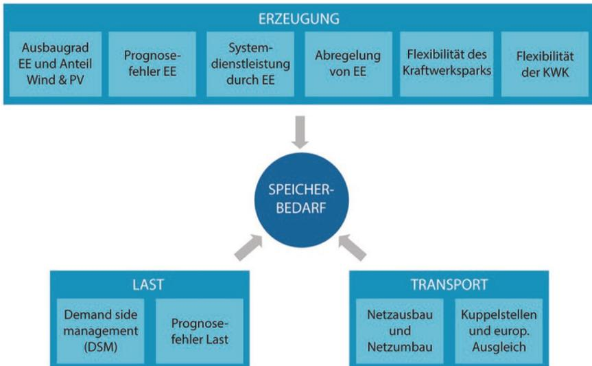
Abbildung 3.11: Einflussfaktoren auf den Stromspeicherbedarf nach [151]
