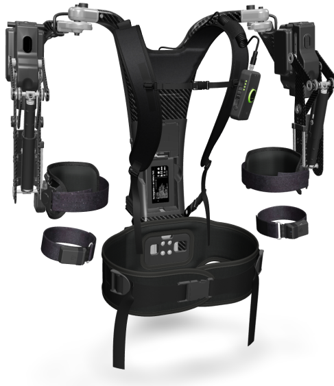
Abb. 4. Aufbau des AGADEXO Shoulder Exoskeletts (Ausschnitt aus animierter 360° Ansicht [2]).
