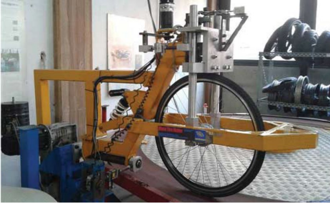
Abbildung 2.5: Messung eines Fahrradreifens auf dem Scheibenprüfstand [Dor13]
