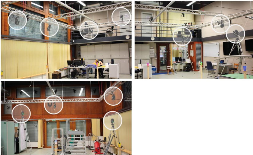
Abbildung 13: Kamerasetup mit 11 Infrarotkameras zur Aufnahme der Objektübergaben.
