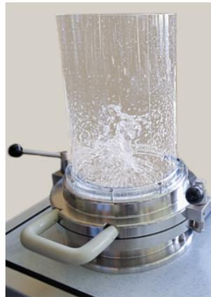
(b) Füllen des Zylinders und Faserzugabe.
