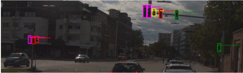
Abbildung 2: Die in Typ und Zustand klassifizierte Ampeldetektion. Die Farbe der Box entspricht dem Ampelzustand. Unbekannte Zustände sind in pinker Farbe gekennzeichnet. Am besten digital zu betrachten.
