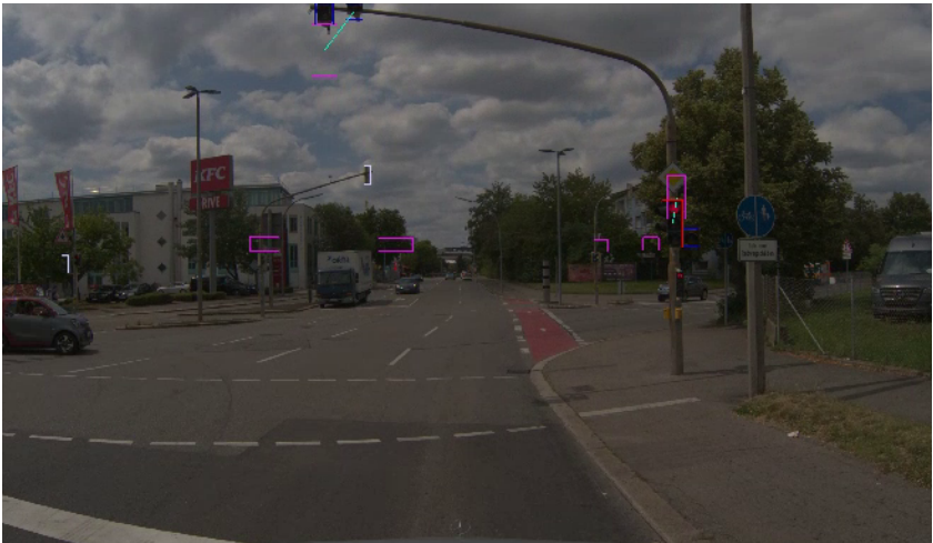
Abbildung 6: hoch montierte (links oben), rot leuchtende Ampeln die teilweise im Bild abgeschnitten werden. Detektiert aber fälschlicherweise als off klassifiziert, da keine rote Leuchte zu sehen ist. Die Haltelinie wird durch zwei Ampeln geregelt, bei einer von zwei falsch klassifizierten Ampeln kann der Filter falsche Ergebnisse liefern.
