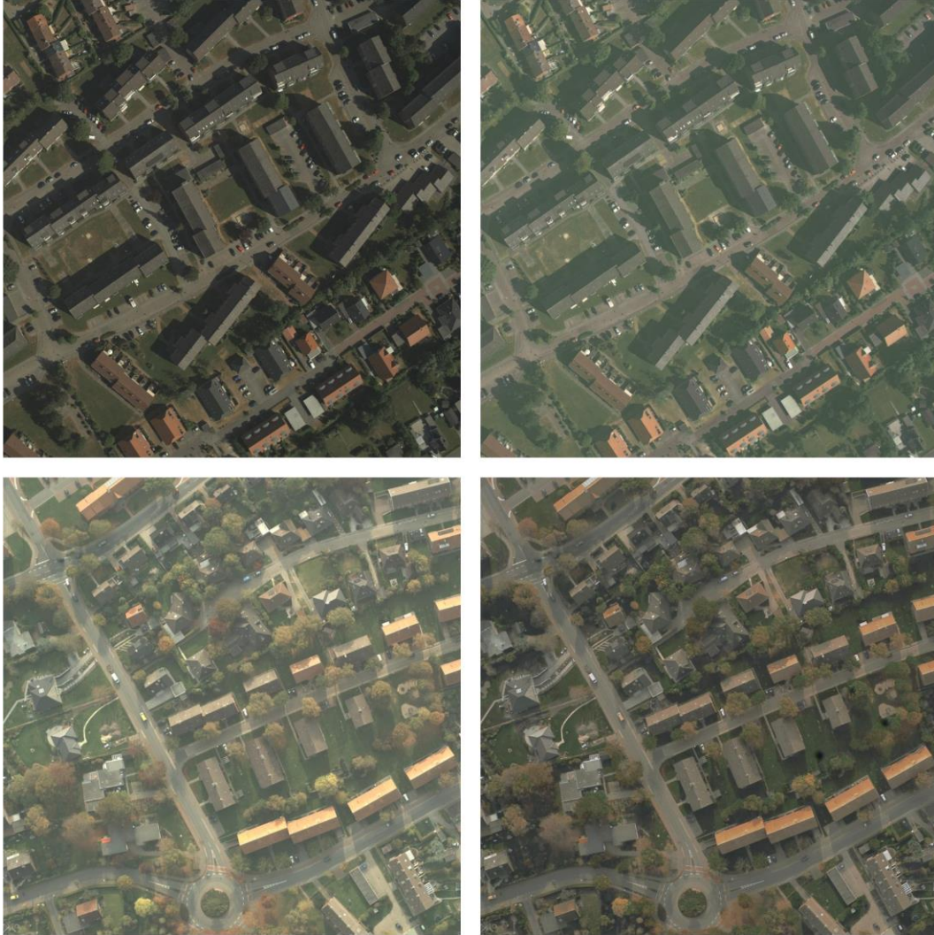
Abbildung 38: Oben links: RGB-Bild von Luftbilddatensatz Sommer. Oben rechts: RGB-Bild von Luftbilddatensatz Sommer nach dem Style-Transfer. Unten links: RGB-Bild von Luftbilddatensatz Herbst. Unten rechts: RGB-Bild von Luftbilddatensatz Herbst nach dem Style-Transfer.
