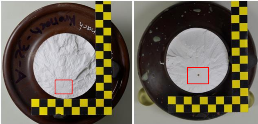
Abbildung 24: Innenliegende Versagensursprünge (gekennzeichnet durch rote Kästen). Bei hohen Bruchspannungen sind "harte Brocken" (links) und "schwarze Einschlüsse" (rechts) häufig zu finden.
