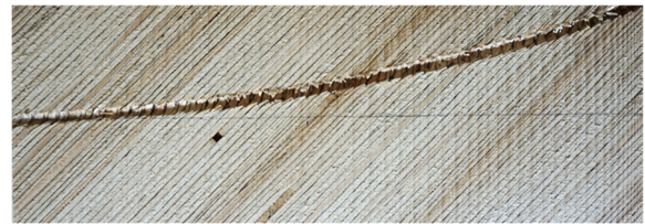
Abb. 6: Verlauf der Schraube 8 x 320 im FSH bei \alpha = 45^\circ .
