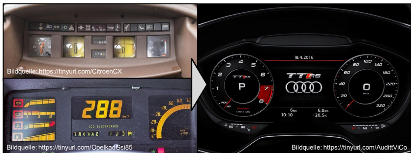
Abbildung 1.1: Links: Walzentacho im Citroën CX von 1974 (oben) und die digitale Instrumententafel im Opel Kadett GSi von 1985 (unten). Digitale Instrumente haben sich im Markt erst 30-40 Jahre später im Audi TT (rechts) durchgesetzt.
