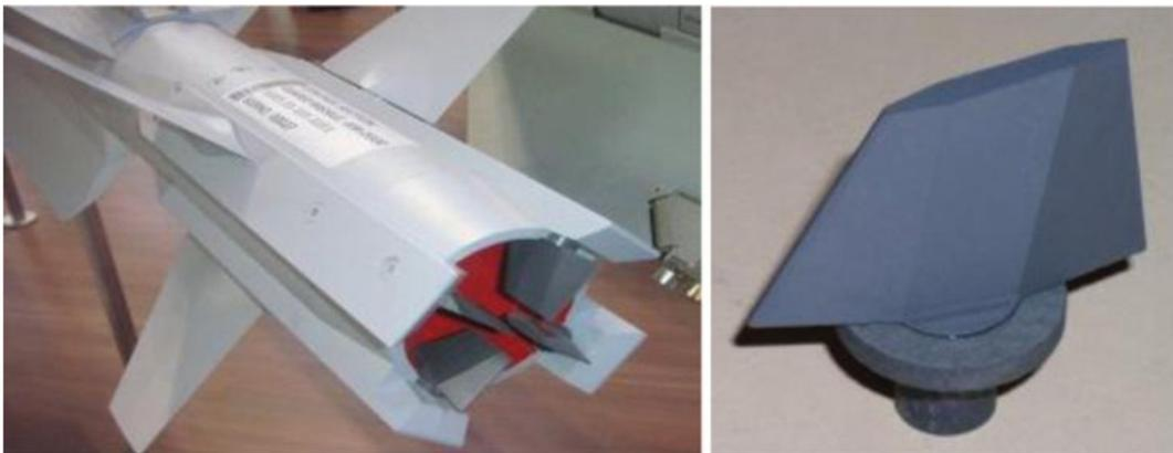
Abbildung 14: System zur Schubvektorsteuerung von Feststoffraketen mit C/C-SiC-Strahlrudern [53]
