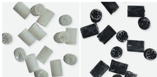
Abb. 2: Füllkörper; links unbeschichtete und rechts beschichtete Füllkörper, Schichtdicke ca. 100 µm (Foto: Eduard Alesi)
