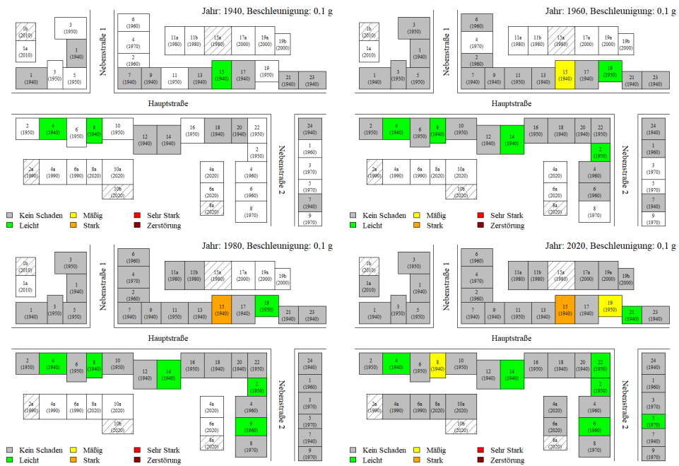
Abbildung III.32: Straßenzug mit 50 Stahlbetongebäuden und fünf Mauerwerksgebäuden (schraffiert) zu den Beobachtungsjahren 1940, 1960, 1980 und 2020 und die zugehörigen Schadensgrade (PGA = 0,1 g)
