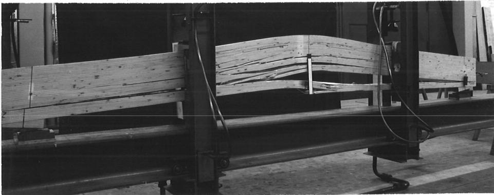
Bild 22: Typischer Querzugbruch bei Bauart 1
