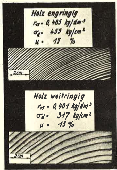
Bild 1 Querschnitt des engringigen und weitringigen Holzes
