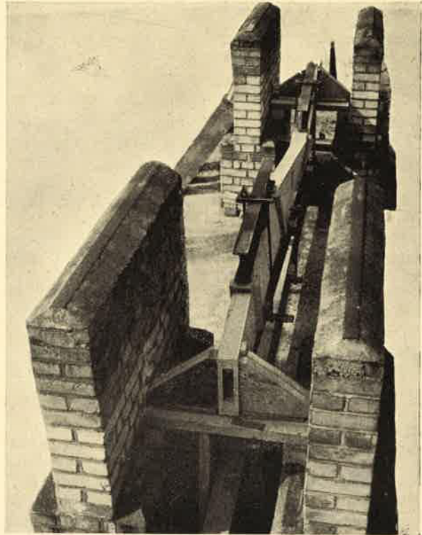
Abb. 26. Der Biegeträger II nach dem Ausknicken seiner Oberkante und nach Entfernung der Führung.
