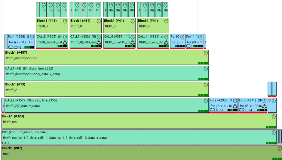
Abbildung 6.12.: FFT auf Task-Ebene mit Optimierung für 4 Kerne und angewendeten Code-Transformationen
