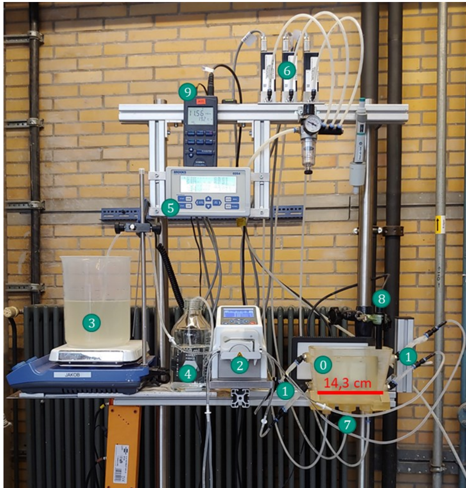
Abbildung A7.1: Versuchsaufbau für die kontinuierliche Flotation im horizontalen Flotationsbecken (0), mit Schläuchen für die Zu- und Ableitungen (1) der mit der 4-Kanal Schlauchpumpe (2) geförderten Phasen, der Vorlage angereicherter Unterphase (3) und Oberphase (4), sowie der Steuereinheit (5) für die drei Massendurchflussregler (6) für die Begasungseinheiten (7) und der Leitfähigkeitsmessung, bestehend aus Sonde (8) und Messgerät (9).
