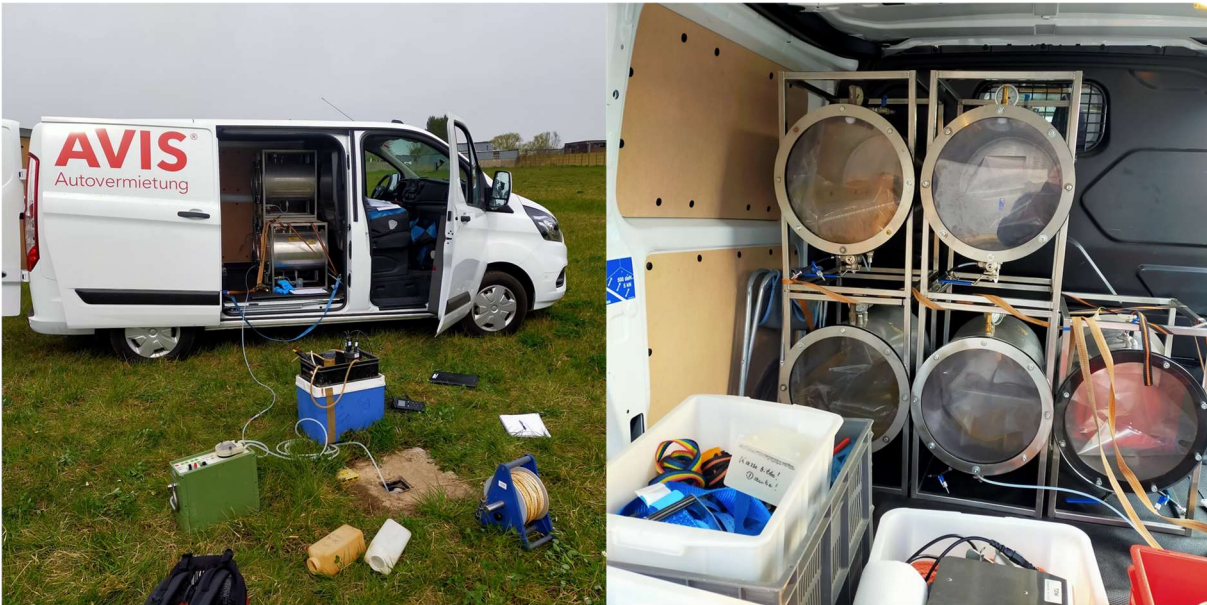
Abbildung 3-2: Beprobung des Piezometers Pz17 am Standort NAM (links); Stahltonnen mit Tedlarbeuteln zur anaeroben Lagerung des Grundwassers bis zum Start der Experimente (rechts).
