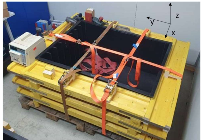
Abbildung 3-6: Schematischer Aufbau der Boxen (links) und tatsächlicher Aufbau der Boxen mit Holzrahmen zur Verstärkung der Stabilität (Abbildungen bereitgestellt durch VEGAS).
