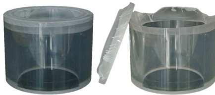
Abbildung 3-2 Bruch eines Perlucor® Zylinders nach stirnseitiger Verklebung mit einer Inconel® 718 Gehäusekupplung; Einkomponenten-Epoxidharzkleber mit \text{Al}_2\text{O}_3 Partikel verstärkt (Kleber der Fa. CeramTec ETEC GmbH); Verbund bei 200 °C unter Luftatmosphäre im Rohröfen ausgehärtet [46]
