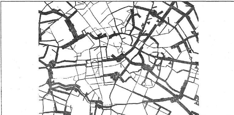
Abbildung 12: Ergebniszuverlässigkeiten nach der Messwertpropagierung. (graue Balken = Zuverlässigkeitswert; schwarze Dreiecke = Messstellen)
